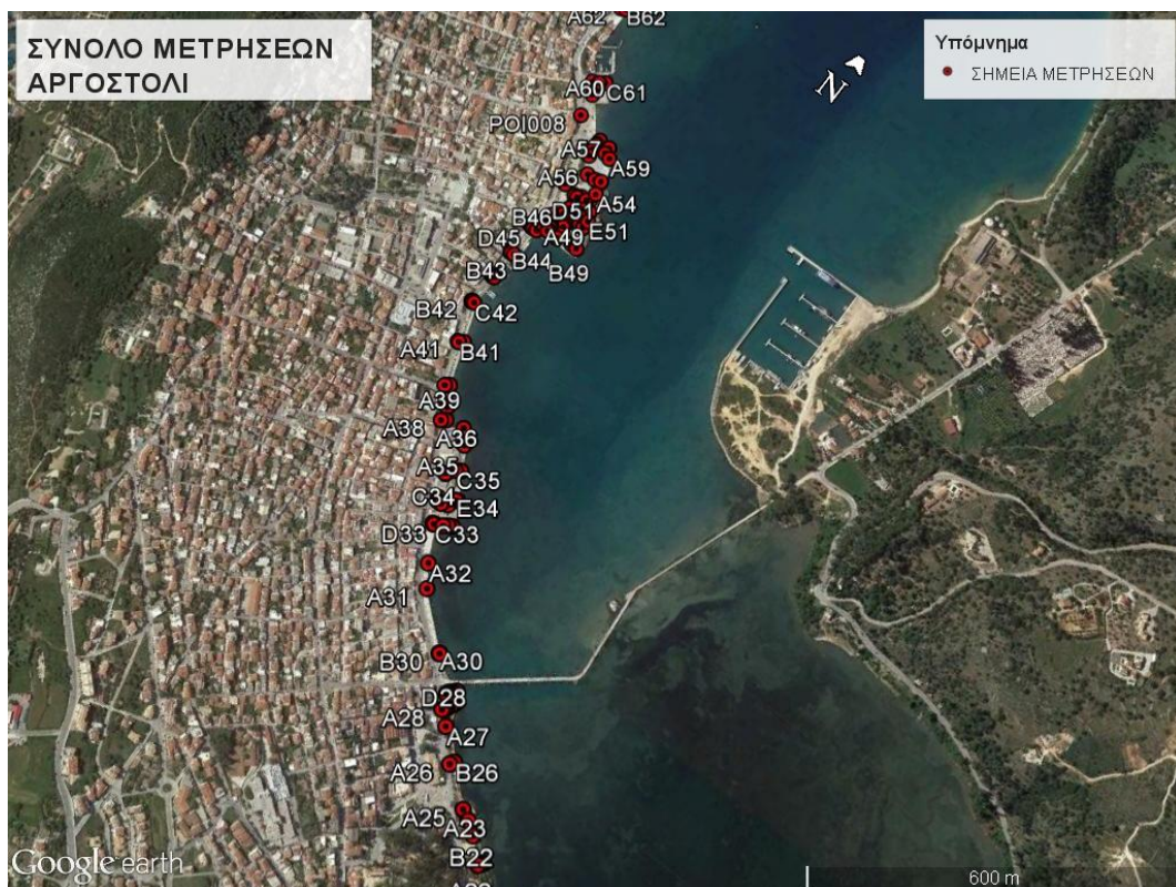
Σχήμα 5-21 Θέσεις μετρήσεων της οριζόντιας μετακίνησης στη παραλιακή ζώνη του Αργοστολίου
