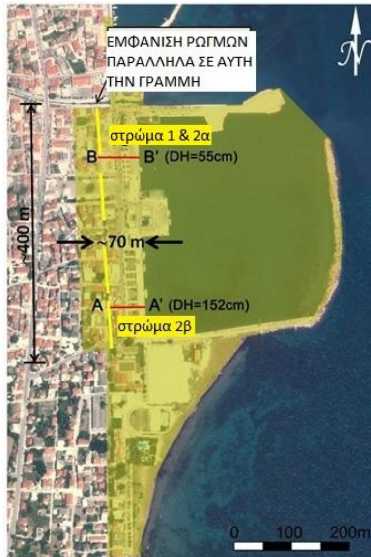
Σχήμα 4-8 Οι οριζόντιες μετακινήσεις εμφανίστηκαν σε ζώνη πλάτους 70 μέτρων στην χερσαία ζώνη και έφτασαν μέγιστη τιμή 1,52m
