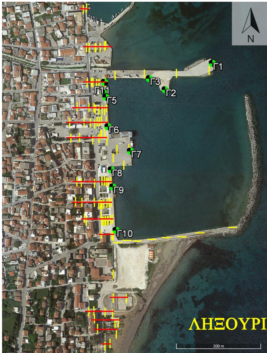
Σχήμα 5-1 Δορυφορική φωτογραφία (Google Earth) του λιμένα Ληξουρίου με τις θέσεις των τομών κατά μήκος των οποίων πραγματοποιήθηκαν οι μετρήσεις μετακινήσεων
